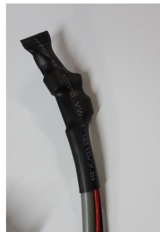
（図 9-4 絶縁処理 2） 絶縁処理例（収縮チューブ）
