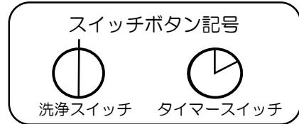
④ 洗浄スイッチを押します、タイマースイッチを使用しない場合は約5分間洗浄し自動停止します
