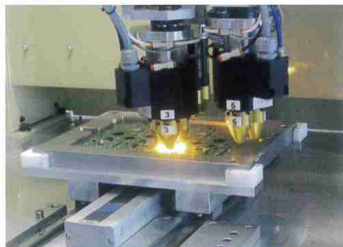
熱や振動の影響によるダメージが少ない為プリント基板のカシメ工程に最適
