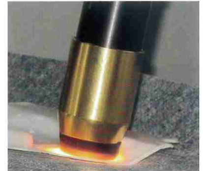
集光部の焦点を変える事でパンチを使わず樹脂の溶着をする事も可能
